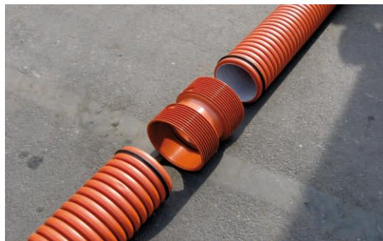
8. ввести трубу в раструб и нажать до отказа до обозначенной черты, при необходимости использовать ручной рычаг либо соответствующий инструмент, сохраняя при этом особую осторожность во избежание повреждения конца трубы,
